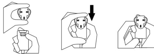
Conectați cablul USB la adaptorul A / C care a venit împreună cu dispozitivul Tractive GPS. Apoi atașați clipul de încărcare de dispozitiv după cum se vede în imaginea de mai jos.
