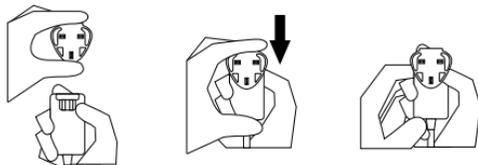
Pripojte priložený USB kábel s A/C adaptérom. Následne pripevnite dobijaciu svorku na zariadenie (p. obrázok).
