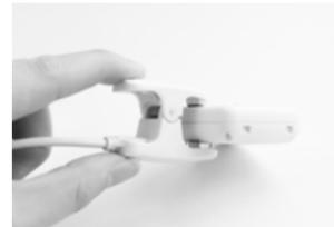
A continuación, sujete la pinza de carga en el dispositivo como se muestra en la siguiente imagen. El led en el dispositivo Tractive® GPS encenderá rojo cuando el dispositivo se esté cargando. Una vez que el dispositivo esté totalmente cargado la luz roja desaparecerá.
