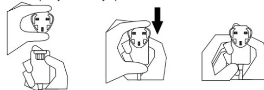
Spojite USB kabel na A/C punjač koji je došao sa Tractive® GPS uređajem. Nakon toga spojite hvataljku za punjenje na uređaj kako je prikazano na slici.
