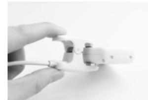
Om het toestel te laden verbindt u de klem van de laadkabel met het toestel zoals in de volgende afbeelding weergegeven.
